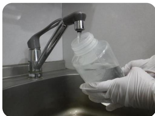
◎試薬の入っている滅菌済みポリ容器(③)は、共洗いをせず、中の試薬がこぼれないようにして、容器の首元まで採水して蓋をしっかりと閉めてください。(フタの内側やネジ部を触らない様にして下さい。)
